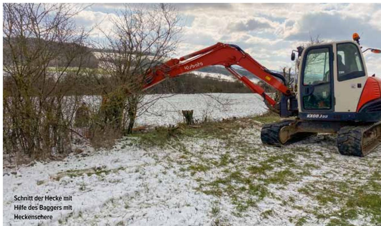
Schnitt der Hecke mit Hilfe des Baggers mit Heckenschere
